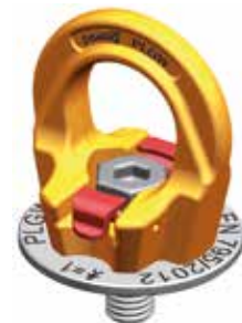
Bild 4: Stellung ‚B‘. Keine Berührung der Sperren mit der Schraube. Nur in dieser Stellung ist der Anschlagpunkt einsatzbereit.
