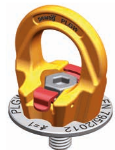
Bild 4: Stellung ‚B‘. Keine Berührung der Sperren mit der Schraube. Nur in dieser Stellung ist der Anschlagpunkt einsatzbereit.
