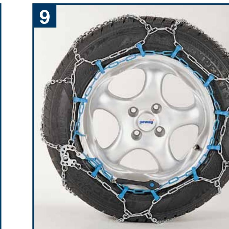
**D** Das freie Ende der Spannkette vom Spannhebel weg zurückführen und um die Spannkette schlingen. Gummispanner in die Spannkette einhängen.
