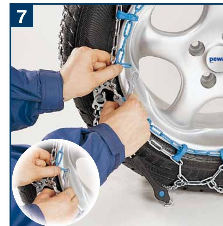
**D** Spannhebel mit Rückhängeglied sichern.
