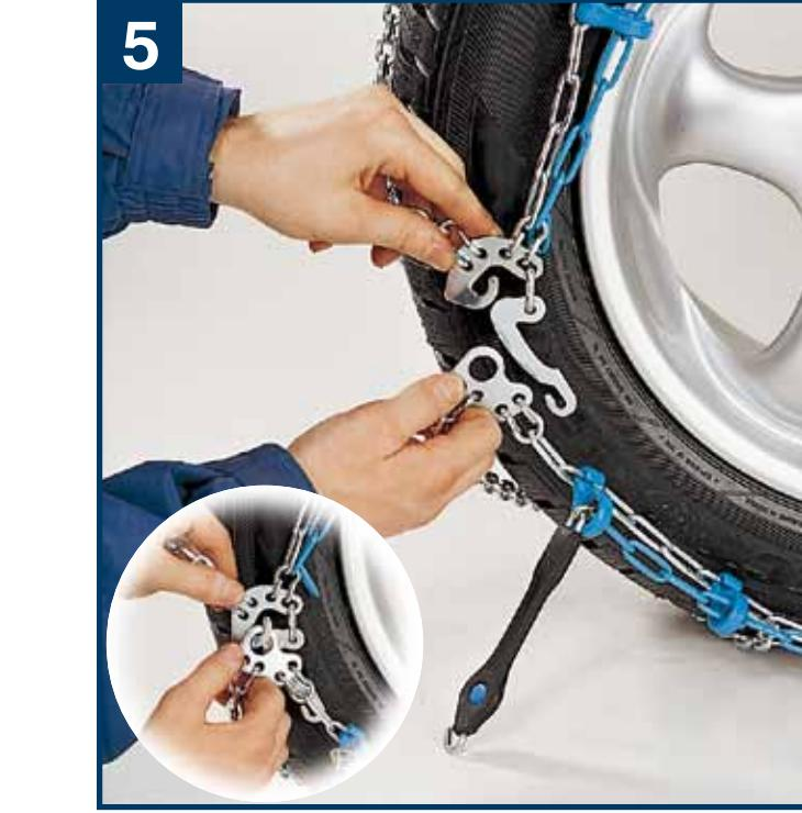
**D** Haken und Öse an der Radaussenseite zusammenhängen.
