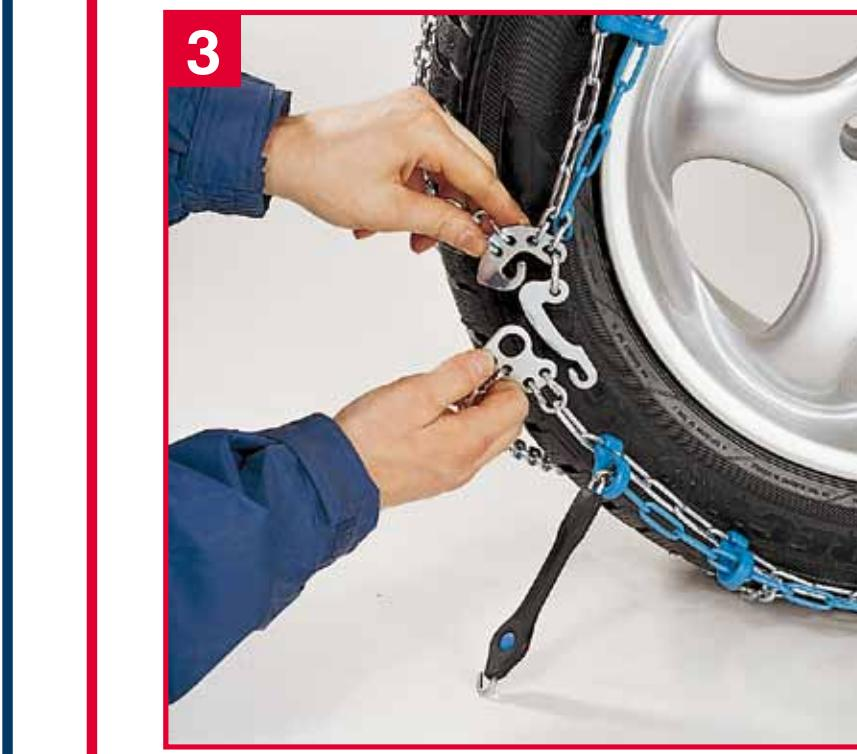
**D** Aussen und innen Haken aushängen und die Kette vom Reifen herunterziehen. Danach mit dem Rad von der Kette fahren.
