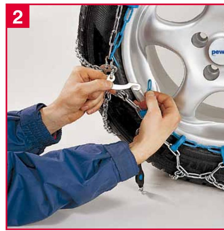
**D** Spannhebel öffnen und Kette lockern.
