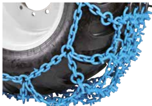
Bsp: in jedem Fall zu lockere Kettenspannung
