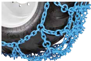
Przykład: łańcuchy za luźne – zarówno na twarde jak i miękkie podłoże
