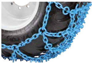
Przykład: poprawne napięcie łańcuchów na podłoże twarde
