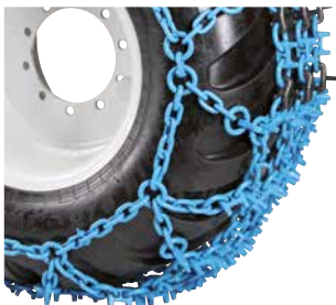
Przykład: poprawne napięcie łańcuchów na podłożu twarde
