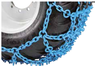
Bsp: korrekte Kettenspannung für harte Untergründe
