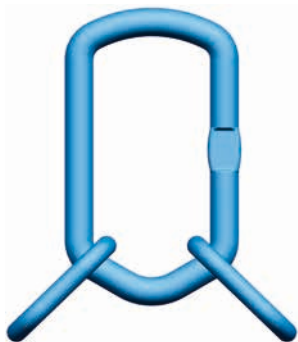
Bild 1 – VLWP mit Neigungswinkel über 45°
